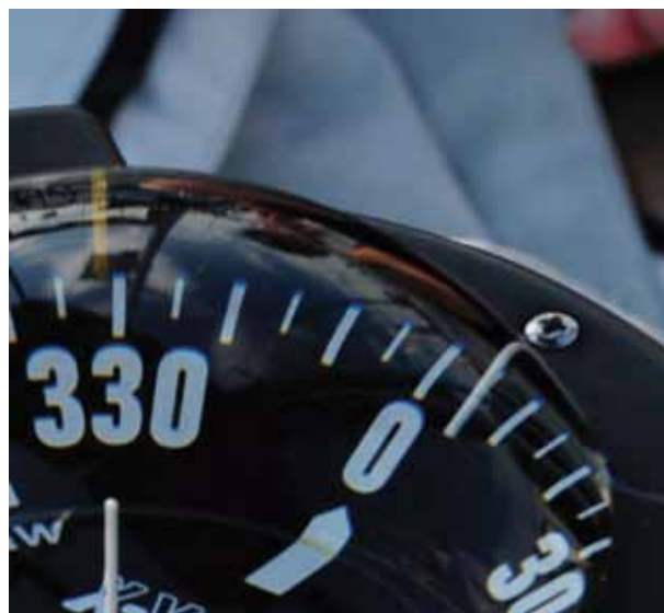
Als Steuerkompass geeigneter Magnetkompass
