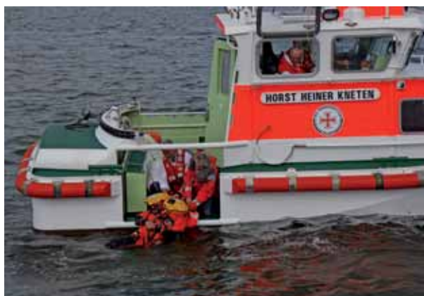
Seenotrettungsboot „Horst Heiner Kneten“ Übung: Rettung eines Schiffbrüchigen durch die Bergungspforte eines Seenotrettungsbootes.
