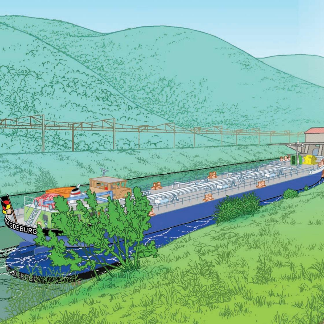
Kurze Zeit später kommt schon das nächste Schiff. Tanja erklärt den Kindern, dass dies ein Tankmotorschiff ist: „Es kann flüssige oder gasförmige Güter, zum Beispiel Benzin, Heizöl oder Erdgas, transportieren. Diese Schiffe haben eine doppelte Hülle, damit bei einem Unfall die gefährlichen Stoffe nicht in das Wasser kommen.“
